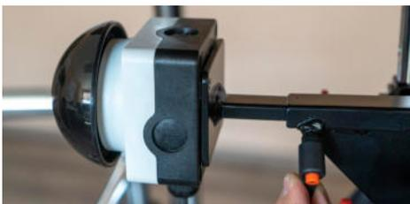
Lösen Sie den Klemmhebel und positionieren Sie den Druckschalter an der benötigten Körperposition des Benutzers. Anschließend ziehen Sie den Klemmhebel wieder fest.
