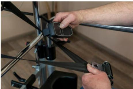
Die Gurte der Gurtaufrollvorrichtung ausfahren, um diese mit dem Patientenhaltegurt verbinden zu können. Das Ausfahren kann sowohl durch die Handbedien­ung als auch durch die pneumatische Saug-Blas-Steuerung (Betätigung mit dem Mund durch den Silikonschlauch mit dem Mundstück) erfolgen.
