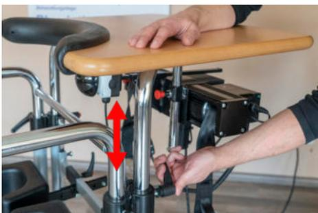
Die Tischhöhe ist durch beidseitiges Lösen der Klemmhebel so einzustellen, dass sich das Polster der Tischplatte in der Stehposition, entsprechend den persönlichen Erfordernissen, zwischen dem Brustbein und der Beckenoberkante befindet.
