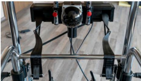
Wir empfehlen, die beiden Gurtzungen etwas auszufahren, so dass diese über die Quertraverse der Handläufe gelegt werden können, damit der Rollstuhlfahrer diese problemlos erreichen kann.
